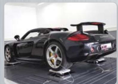
Dämpferprüfstand und hochmoderner 7-Post Fahrdynamik-Prüfstand
