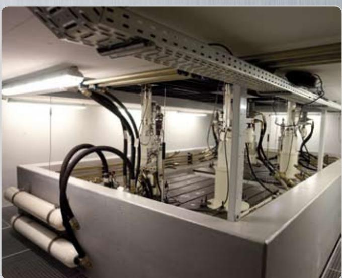
2006 wurde am Standort der KW automotive GmbH in Fichtenberg ein hochmoderner hydraulischer 7-Post-Fahrdynamik-Prüfstand in Betrieb genommen, womit Rennstreckenverläufe simuliert werden können. Diese Technologie bietet der Firma KW ungeahnte Testmöglichkeiten für Anwendungen in der Automobilindustrie und im Motorsport.
