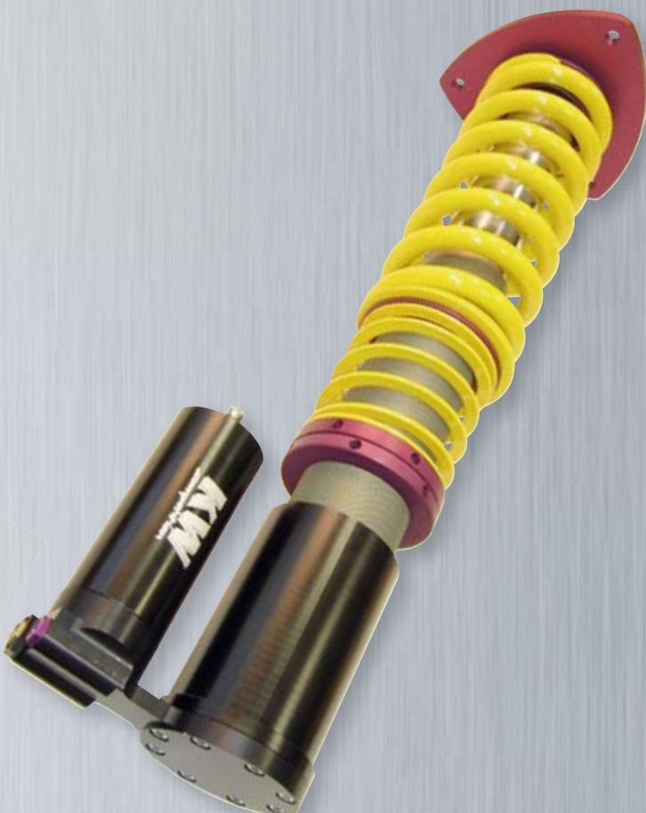
Für die populärsten Rallyefahrzeuge bieten wir zusätzlich spezielle Rallyefahrwerke mit gefrästen Befestigungsschellen und hochfesten Aluminiumgehäusen an. Diese „sealedunits“ sind ohne Schlauch zusammen mit dem Ausgleichbehälter als kompakte stabile Einheit ausgeführt. Der Führungsrohrdurchmesser beträgt 50 mm. Der Vorteil liegt darin, dass kein Schlauch durch das Stützlager geführt werden muß, was insbesondere bei Gr. N Fahrwerken das regelmäßige Wechseln des Stützlagers erleichtert.
